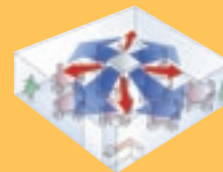
Roundflow 360° luchtuitblaaspatroon zorgt voor een optimale luchtverdeling
